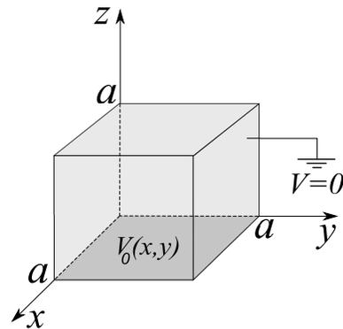
Figura 2: Cubo de lado  $a$  aterrado em todas as faces, exceto em  $z = 0$ , onde o potencial elétrico é especificado por  $V_0(x, y)$ .
