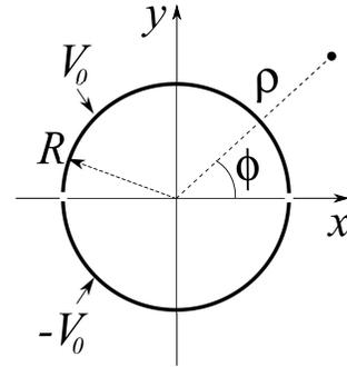
Figura 4: Semicilindros condutores. Um deles fica compreendido em  $0 < \phi < \pi$  mantido em um potencial elétrico uniforme  $V_0$ . O outro fica compreendido em  $\pi < \phi < 2\pi$  mantido em um potencial elétrico uniforme  $-V_0$ .
