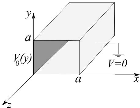
Figura 1: Ilustração de um corte da seção quadrada de um tubo longo. As placas metálicas em  $y = 0$ ,  $y = a$  e  $x = a$  estão aterradas, ao passo que a superfície lateral em  $x = 0$  é mantida sob potencial controlado  $V_0(y)$ .
