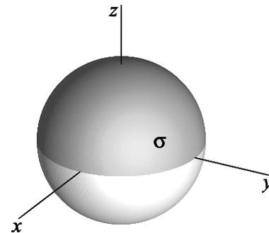
Figura 5: Superfície esférica de raio  $R$ , com um hemisfério superior com densidade uniforme  $\sigma$  e um hemisfério inferior com densidade nula.
