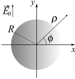
Figura 3: Representação esquemática de um sistema de coordenadas em uma secção transversal de um cilindro condutor longo de raio  $R$ , posto numa região com campo elétrico inicialmente uniforme  $\vec{E}_0 = E_0 \hat{y}$ . As coordenadas assumidas são as coordenadas cilíndricas polares  $(\rho, \phi)$ .
