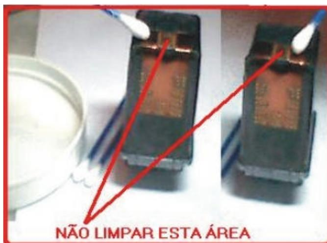
**Limpeza do Suporte dos Cartuchos / Base:** Limpe com cotonetes umedecidos as áreas indicadas com as setas vermelhas. Retire todo o acúmulo de tinta e sujeira nestas regiões. Limpe também a parte interna nos pontos indicados.
