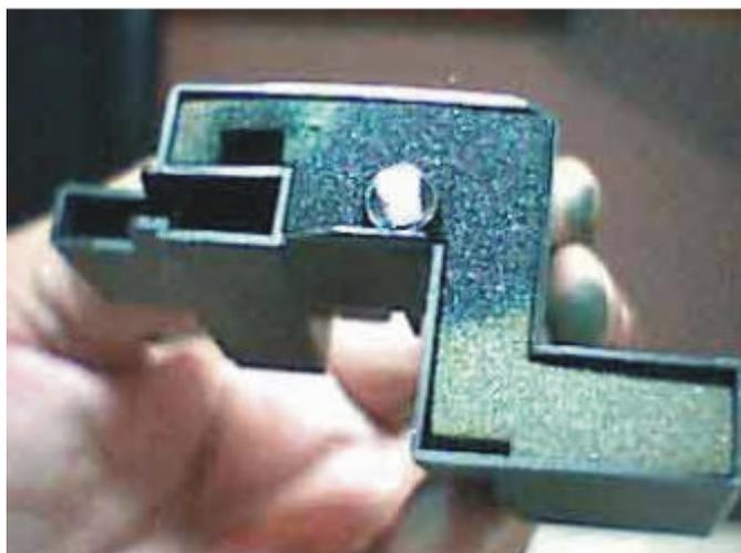
**Lubrificação do Eixo:** O eixo deve ser limpo e lubrificado com óleo fino, isto corrige ruídos durante a movimentação do carro da impressora.
