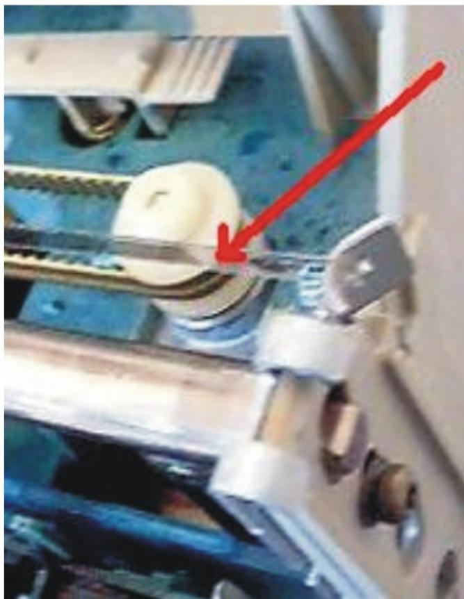
**Limpeza dos Cartuchos:** Limpe com um cotonete umedecido as partes mostradas na foto abaixo, menos a área mostrada com a linha vermelha e os contatos elétricos. Use álcool isopropílico.
