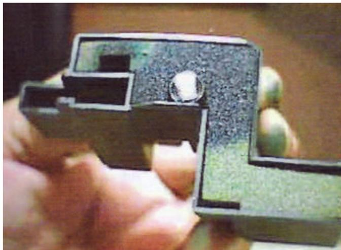
14. Estação de Serviço: localize o parafuso conforme mostra a figura abaixo e retire-o utilizando uma chave torx nº. 10.
