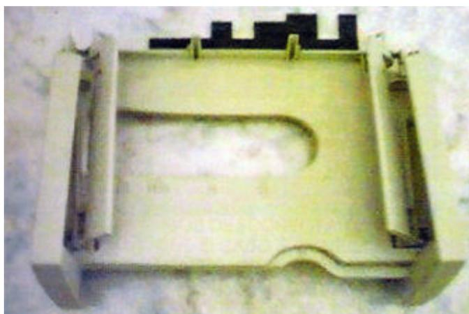
4. Com a ajuda de uma chave de fenda pequena, retire a régua de alinhar papel. Observe que na parte metálica abaixo da impressora tem um local para destravar a régua.
