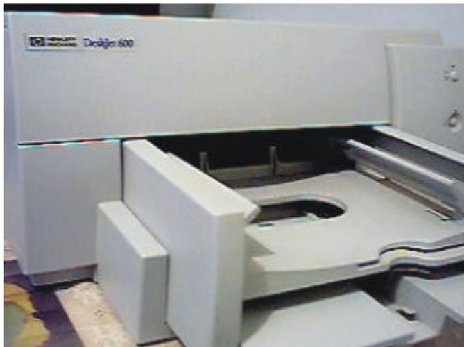
**Limpeza do Tractionador:** A função do conjunto dos três rolos de borrachas é o de carregar uma única folha na impressora. O acúmulo de sujeiras nas borrachas tornam sua superfície lisa fazendo com que o papel não seja puxado pela impressora. O procedimento de limpeza é simples, basta limpá-los com um pano umedecido que não solte fiapos. Vá girando cada um dos rolos com a mão para limpar toda sua superfície. Existem no mercado alguns produtos específicos para limpeza dos roletes de borracha.
