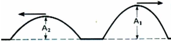
Interferência Destrutiva - 2ª situação, no instante da superposição dos pulsos em oposição de fase, conforme a figura a seguir, cada ponto possui uma elongação  $Y$  igual a diferença das elongações  $Y_1$  e  $Y_2$  que cada ponto produziria se chegasse sozinho. Portanto a crista resultante tem uma amplitude igual a diferença das amplitudes individuais.
