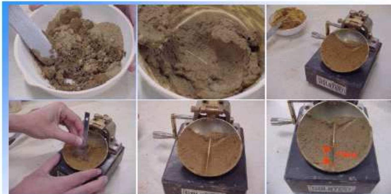
Ensaio de Limite de Liquidez (Aparelho de Casagrande)
