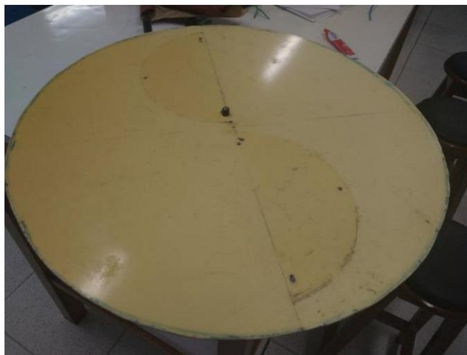
**Figura 35** - Placa de Extremidade feita de PVC.
