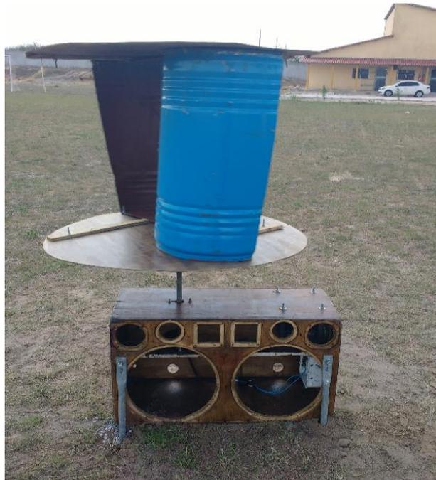
**Figura 44** - Rotor acoplado a estrutura da turbina.
