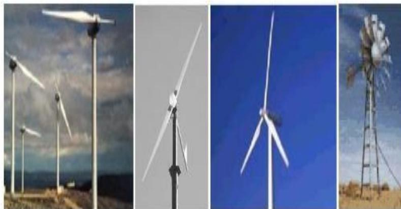
**Figura 10** - Demonstração de aerogeradores de uma pá, duas pás, três pás e múltiplas pás.
