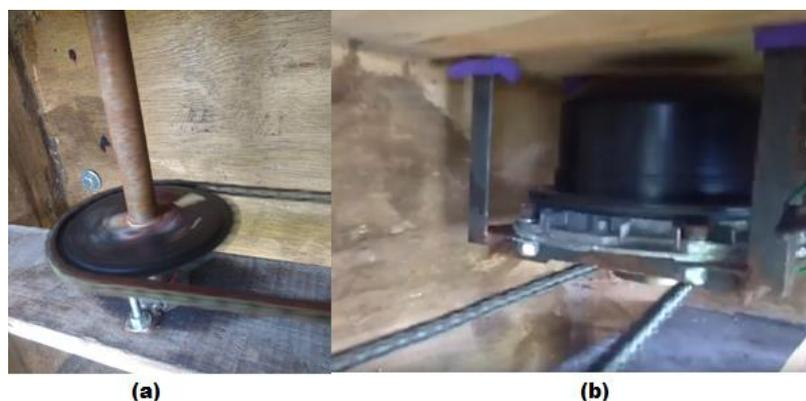
**Figura 46** - Sistema multiplicador de velocidade, (a) Catraca maior, (b) catraca menor.
