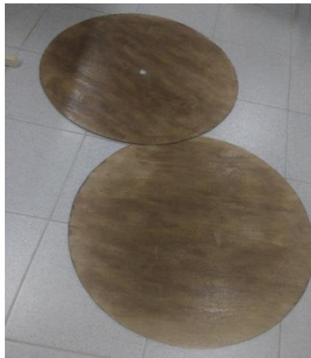
**Figura 42** - Placa de extremidade de madeira MDF.
