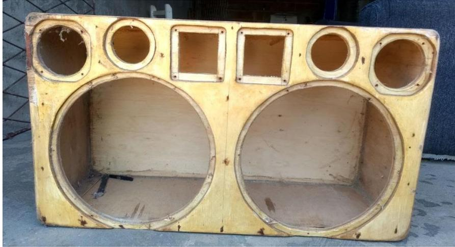
**Figura 23** - Estrutura de caixa de som de madeira.
