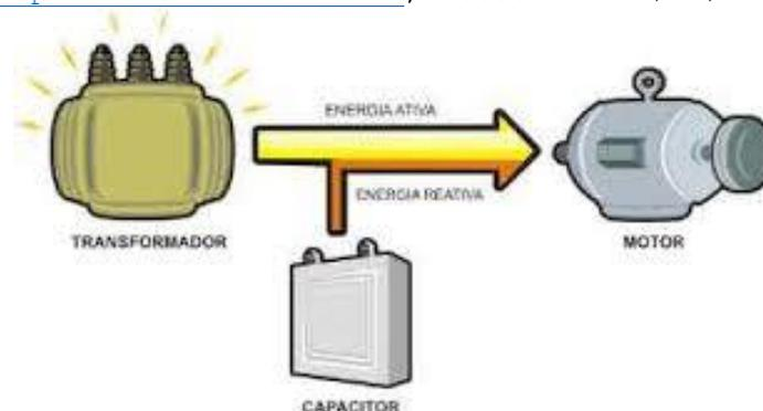
**Figura 22:** Princípio da correção do F.P. em circuitos com motores e transformadores, disponível em: <http://www.ceripa.com.br/Manual%20Reativo.pdf>, acesso em 21/11/2016.
