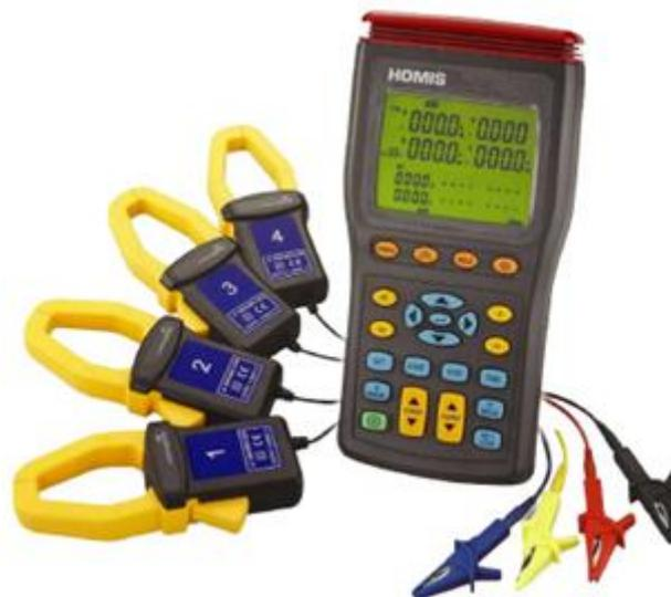
**Figura 17:** Analisador de qualidade de energia, disponível em: <http://homis.com.br/eletrica/analísadores-de-energia/analísador-de-qualidade-de-energia-trifasico-hae-303>, acesso em 12/11/2016.
